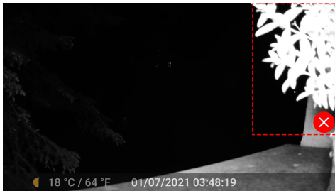
Figur 6: Se till att inte placera några hinder precis framför kameran
