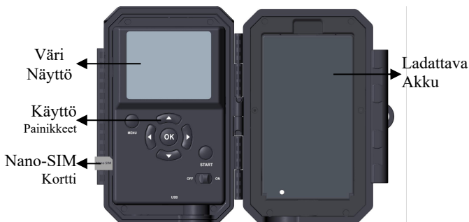
Kuva 4: Sisänäkymä ja esiasennettu SIM-kortti
